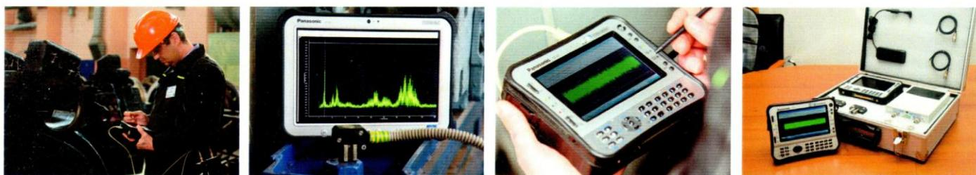
Это, во-первых - универсальный комплекс вибродиагностики буксовых узлов колесных пар с цилиндрическими подшипниками и подшипниками кассетного типа. Комплекс предназначен для вибродиагностики буксовых узлов колесных пар при промежуточной и полной ревизии букс. В состав комплекса входят: система ОМСД-02 или СБД-1, стенд СВ-01НМ1;
